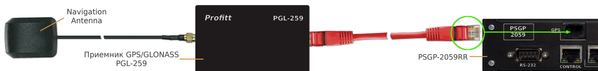
Рис. 4. Подключение внешнего приёмника GPS/GLONASS PGL-259 к PSGP-2159RR
