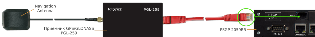
Рис. 4. Подключение внешнего приёмника GPS/GLONASS PGL-259 к PSGP-2059RR
