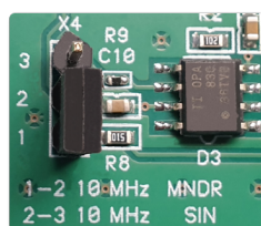
Рис. 18. Переключка X4 выбора формы сигнала 10 МГц
