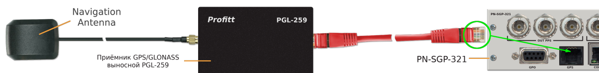
Рис. 4. Подключение внешнего приёмника GPS/GLONASS PGL-259 к PN-SGP-321(RR)
