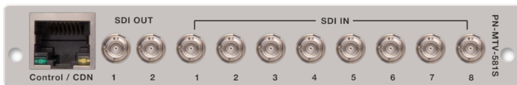
Рис. 3. PN-MTV-581S. Задняя панель.
